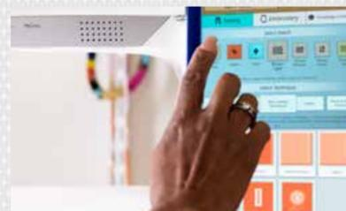
Wählen Sie die Stoffart und eine der vielen verfügbaren Techniken. Die Funktion JoyOS ADVISOR™ stellt dann den optimalen Stich, die Stichbreite und -länge, die Fadenspannung und -zuteilung sowie den Nähfuß ein – ganz automatisch für Sie ein.
